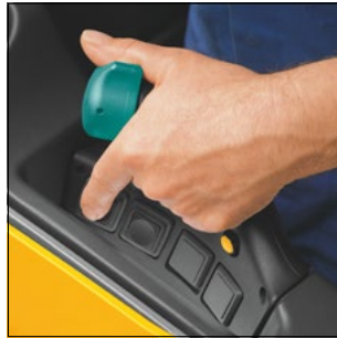
ESD 120: Στοιχείο χειρισμού για τη ρύθμιση της ταχύτητας και τη λειτουργία ανύψωσης
