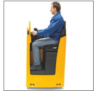
Άνετη θέση καθίσματος με λαμαρίνα δαπέδου ρυθμιζόμενη σε ύψος στο ESE 220/320
