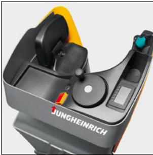
Οχημα όρθιου χειριστή ESE 120 με εύκολα προσβάσιμα στοιχεία χειρισμού και πτυσσόμενο κάθισμα
