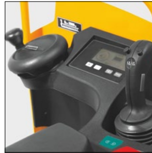
Χειρισμός όλων των λειτουργιών οδήγησης και ανύψωσης με τον μοχλό πολλαπλών λειτουργιών στο ESE 220/320
